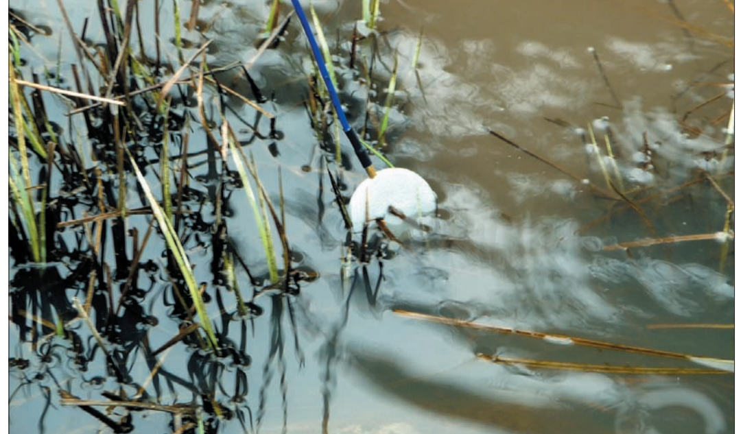
Hydrofoni eli vedenalainen mikrofoni rantavedessä.
